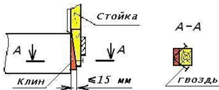
Рисунок 17 – Крепление стойки в стоечной скобе платформы
